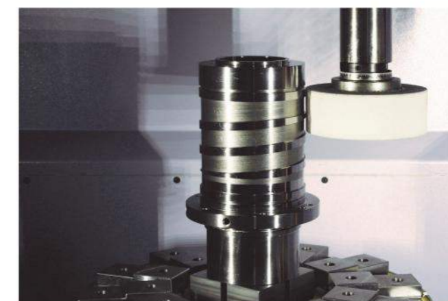
光碟片模具 Disc Mold grinding
